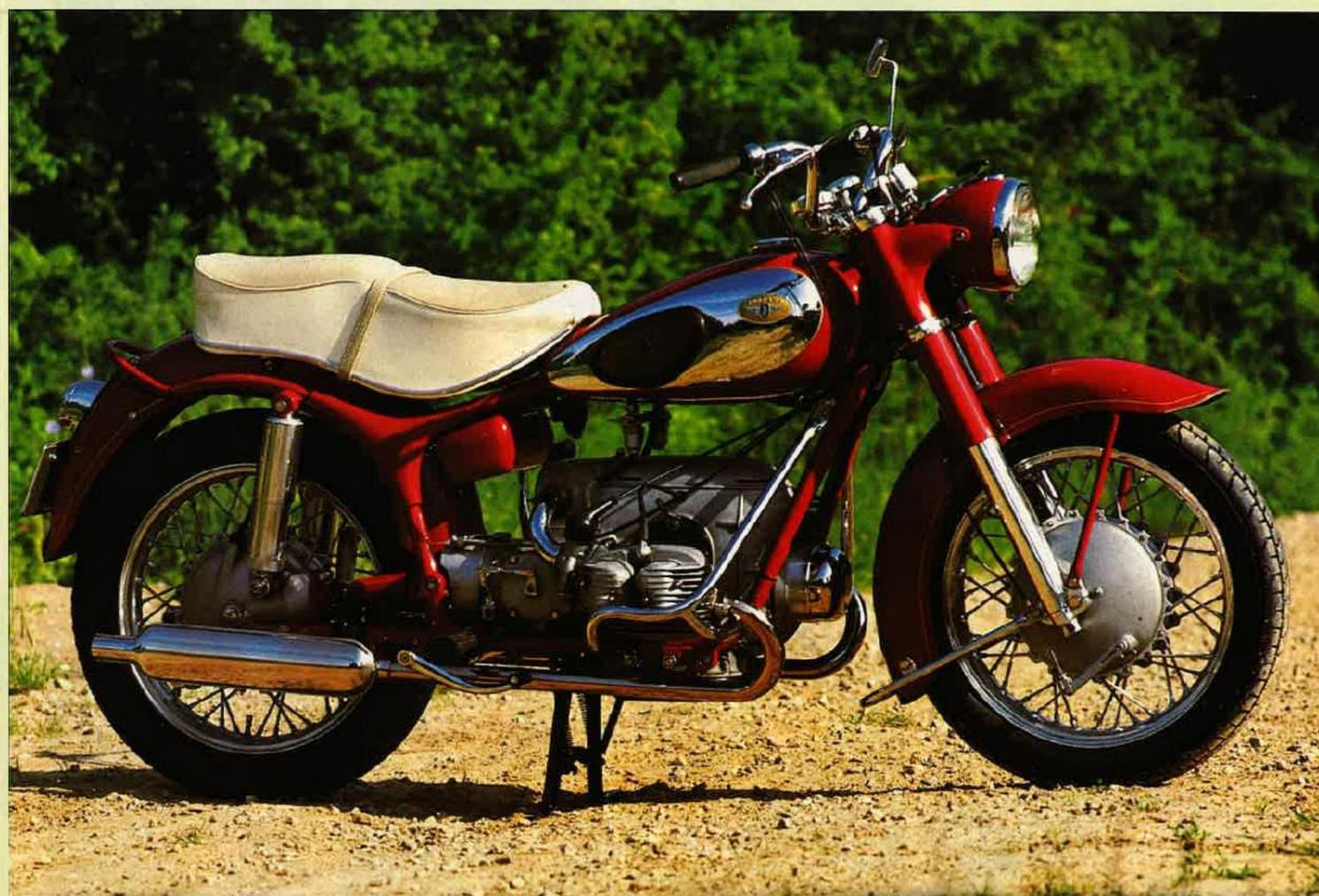
La fameuse KS « Elastic » à suspension oscillante ne fut commercialisée qu'aux USA. Grand guidon et réservoir chromé.
