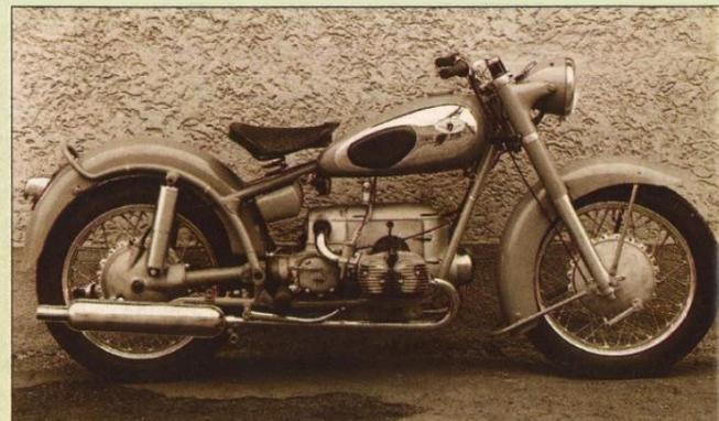
Prototype de l'Elastic vers 1955, l'arrière du cadre est encore juste soudé
