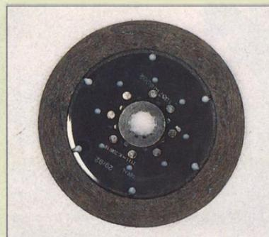
Pièces d'usure telles que disques de friction d'embrayage
