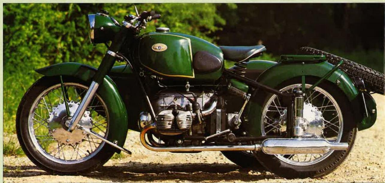
Gros réservoir et moyeux en alliage léger, ici aussi les roues sont interchangeables, d'où la roue de secours
