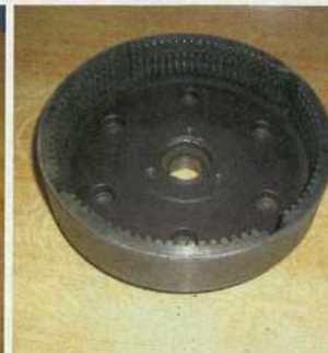
Schwergewicht: das Schwungrad, das gleichzeitig Kupplungskorb ist
