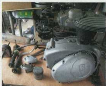
Unter dem rechten, bauchigen Motordeckel arbeitet die Kupplung
