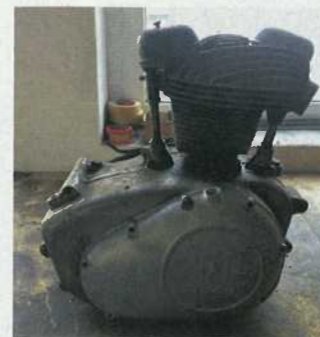
Erkennungsmerkmal: die Stößelhüllrohre vor und hinterm Zylinder
