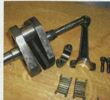
Auffällig: der doch arg dünne Kurbelwellenzapfen auf der Abtriebsseite
