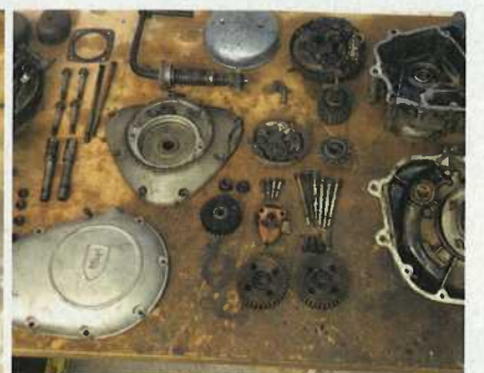
Lager, Dichtungen, neue Ventile und ein neuer Kolben – mehr Teile waren nicht nötig
