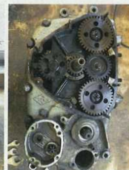
Aufwendig: der Antrieb von Nockenwellen und Ölpumpe
